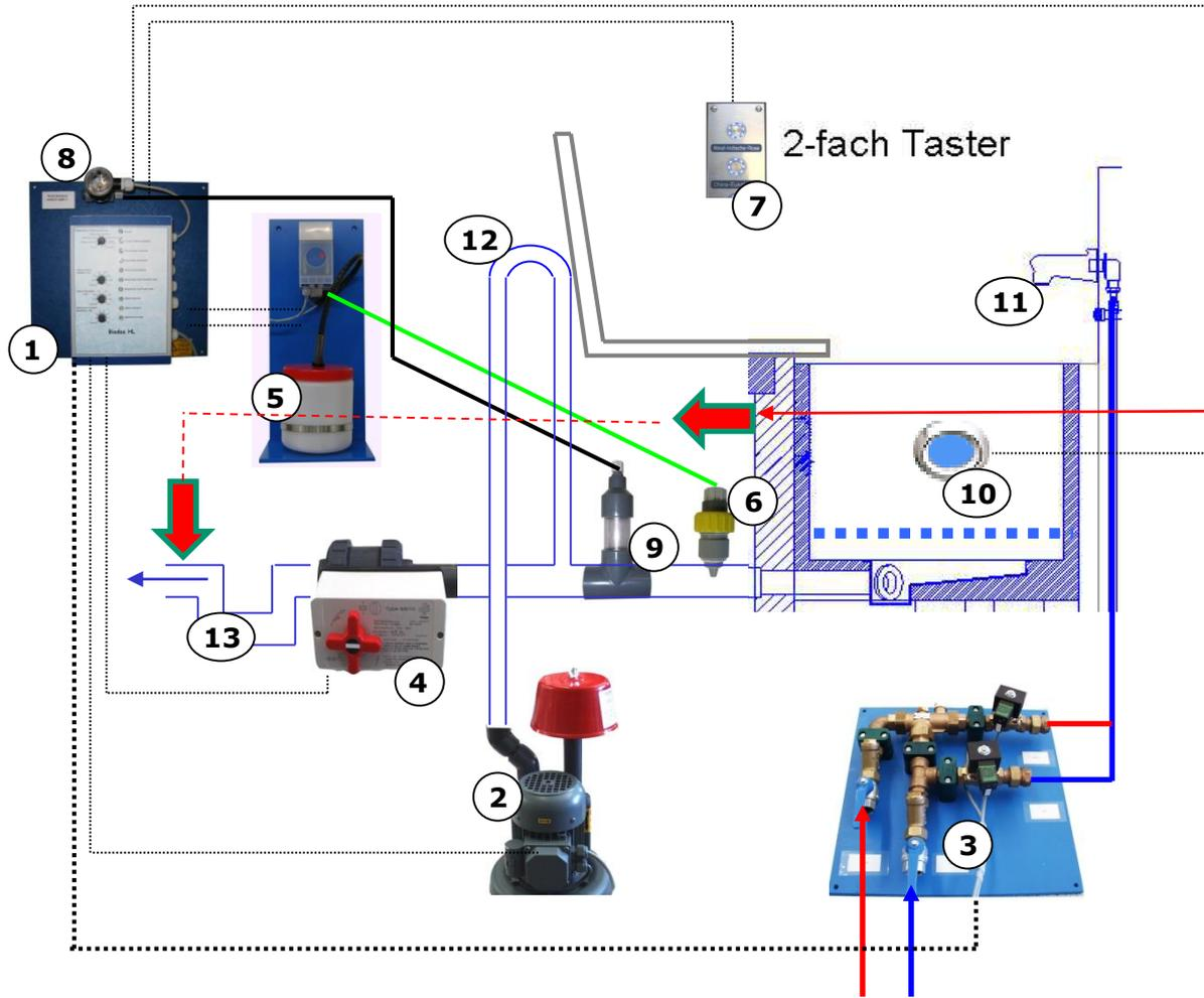
Überlauf des Beckens muss nach Motorventil am Ablauf angeschlossen werden!
